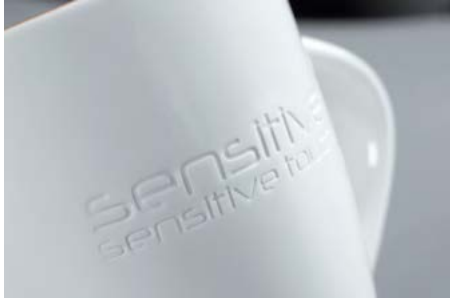
Piaskowanie na białym szklwie Sandblasting on white glaze
